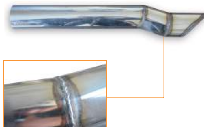
SPAWANY ELEMENT PRZED OBRÓBKĄ
