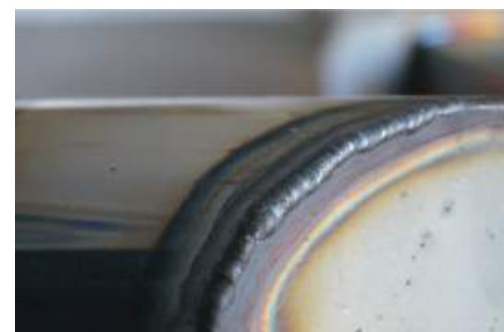
SPAWANY ELEMENT PRZED OBRÓBKĄ
